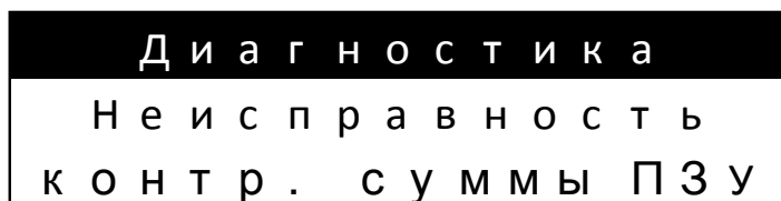
Рисунок 5.3.1.13 – Сообщение о неисправности контрольной суммы ПЗУ
